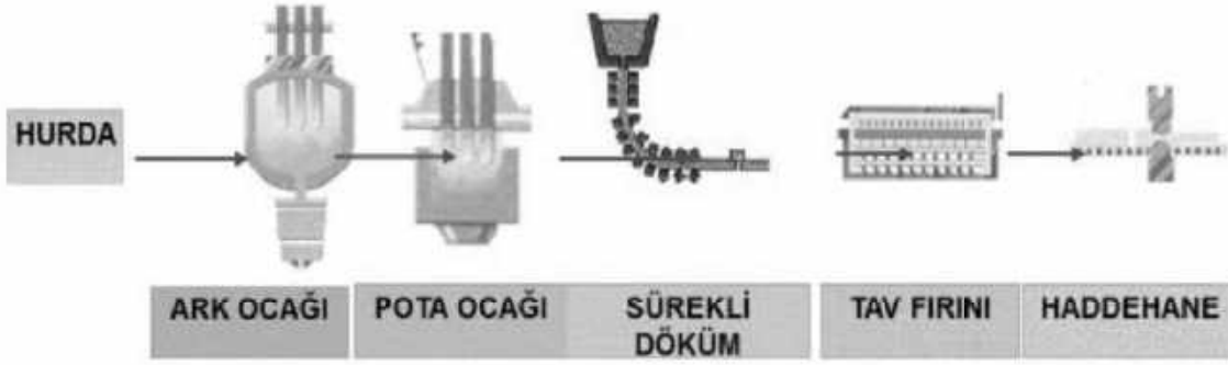
Şekil 2: EAF'li tesiste üretim akış şeması
